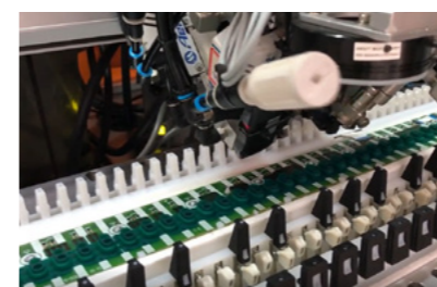
鍵盤の自動組み立てライン
