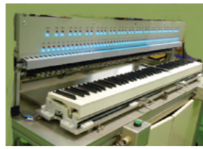
ピアノ鍵盤生産ラインの自動音質検査機
